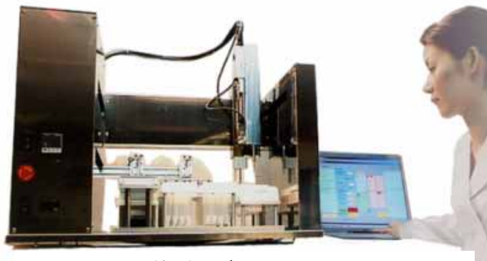
図2 結晶化ロボット“TASCAL”
